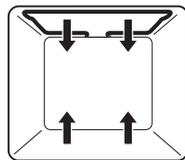
Le chauffage est effectué par les corps de chauffe supérieur et inférieur.
