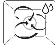
L'air de l'espace de cuisson est chauffé par le corps de chauffe situé derrière la paroi arrière de l'espace de cuisson et circule de façon homogène. L'humidité qui se dégage des aliments est conservée dans l'espace de cuisson. L'aliment à cuire sèche moins.
